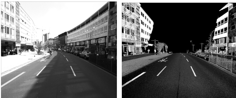
Abb. 3: Optisches Bild einer rückwärtsgerichteten Industriekamera (links) und verdichtetes Intensitätsbild aus der Punktwolke (rechts).
