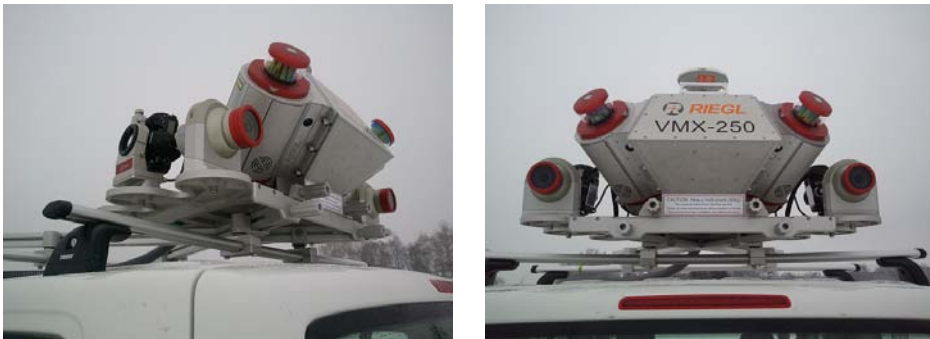
Abb. 2: Mobile Mapping System Riegl VMX-250-CS6 mit zwei seitlich ausgerichteten Spiegelreflexkameras und zwei rückwärtig gerichteten Industriekameras.
