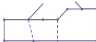
Abbildung 9: Der Split-Operator teilt Polygone an schmalen Stellen, sofern dort ein Knoten höherer Ordnung oder eine konkave Ecke vorliegt. Existiert auf der Gegenseite kein Knoten in der Nähe, wird stattdessen der Lotfußpunkt verwendet.
