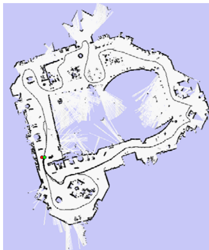
Abbildung 4: SLAM: Eine von einem Roboter erstellte Repräsentation (Map) der Umgebung. Quelle: Sebastian Thrun, Stanford University (Thrun 2006).
