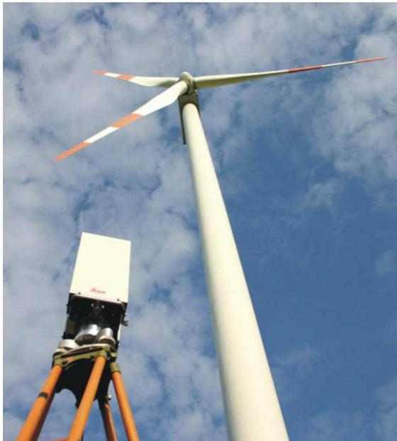
Abb. 5.3: Terrestrischer Laserscanner vor einer Windenergieanlage
