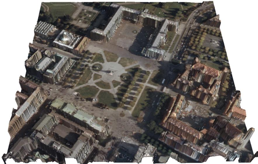
Abbildung 3: DHM aus Laserscanning mit überlagertem Luftbild
