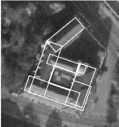
Abbildung 5: Rechteckzerlegung des Grundrisses
