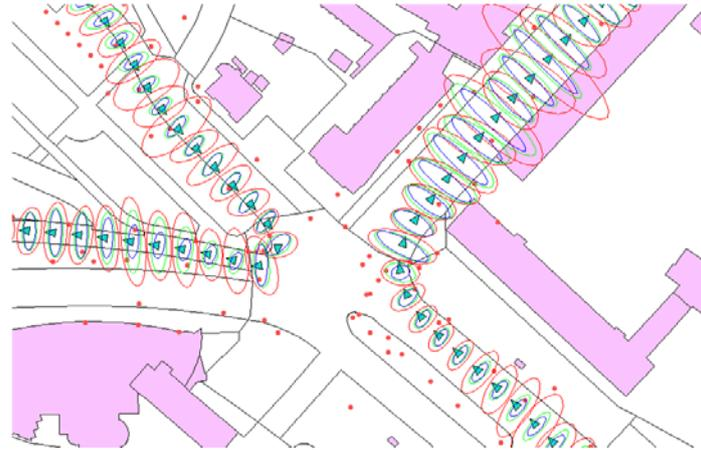
Abb. 4: Fehlerellipsen zur erwarteten Genauigkeit der Positionsbestimmung bei einer Maximaldistanz des Sensors von 50 m (rot), 100 m (grün) und 150 m (blau). Die Ellipsen sind 100-fach überhöht.
