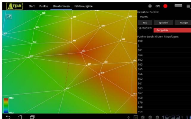
**Abbildung 1.** Erfassen von Geripplinien. Zwei Punkte werden in der räumlichen Darstellung angetippt aus der Liste mit Punktnummern (rechts) ausgewählt. Entsprechend wird eine neue Geripplinie (rot strichliert) erstellt.
