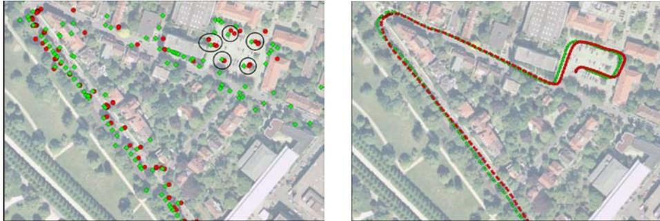
**Abb. 5** Links: Vergleich von Referenzstangen (grüne Quadrate) mit aus RTS Hanna Scans extrahierten Stangen (rote Punkte). Rechts: Vergleich der Originaltrajektorie (rote Punkte) mit der korrigierter Trajektorie (grüne Quadrate).
