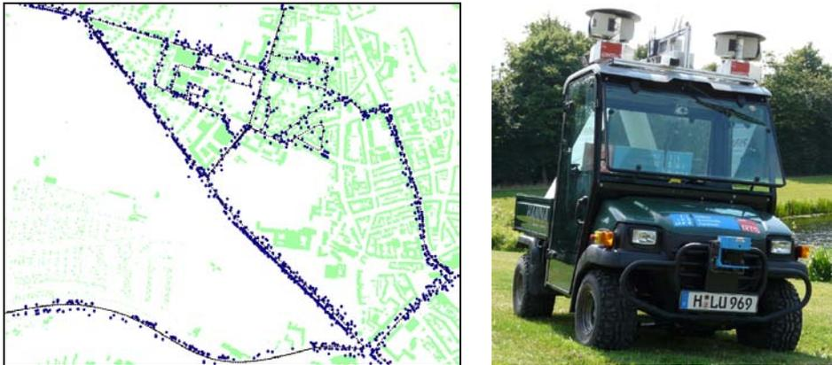
**Abb. 1** Links: Extrahierte Stangen (blaue Punkte) für einen Teil der Trajektorie (gepunktete Linie). Rechts: RTS Hanna Fahrzeug (Mit freundlicher Genehmigung des ISE/RTS).
